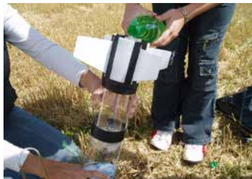
Was treibt eine Rakete in die Höhe? Ob groß oder klein – alle Raketen arbeiten nach dem gleichen Prinzip. Hier wird es entschlüsselt an der Wasserrakete „Shooter“.
